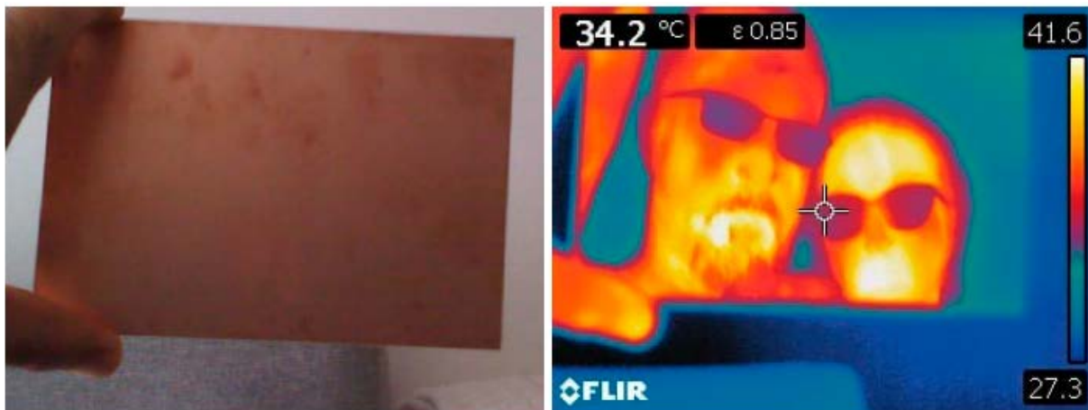
Figura 1. Fotografías de la misma superficie metálica "mate" en el visible (izquierda), que se comporta como un espejo en el infrarrojo (derecha).
